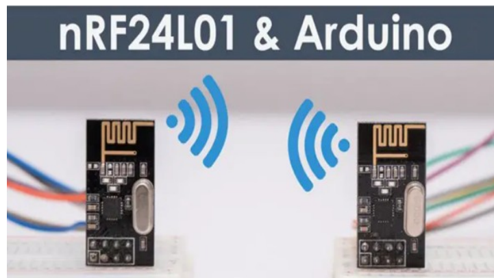
Рисунок 2.16 – Застосування радіомодулів nRF24L01, керованих пристроями Arduino, для безпроводної передачі даних
