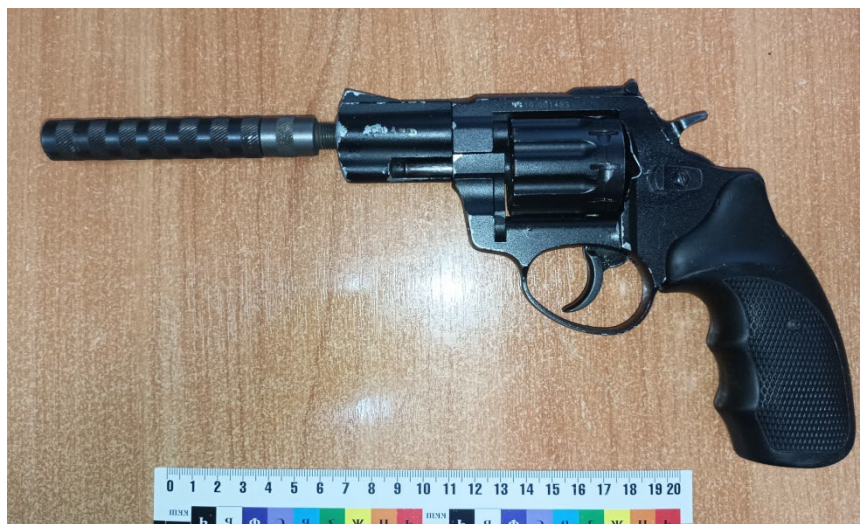
Фото 2: Встановлення адаптеру (у вигляді подовжувача ствола) на пристрій для відстрілу 4 мм патронів Флобера
