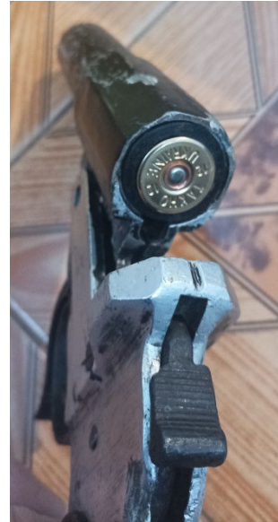
Фото 4: Сигнальний пістолет LP-34 із встановленим адаптером у вигляді вставного ствола та патроном
