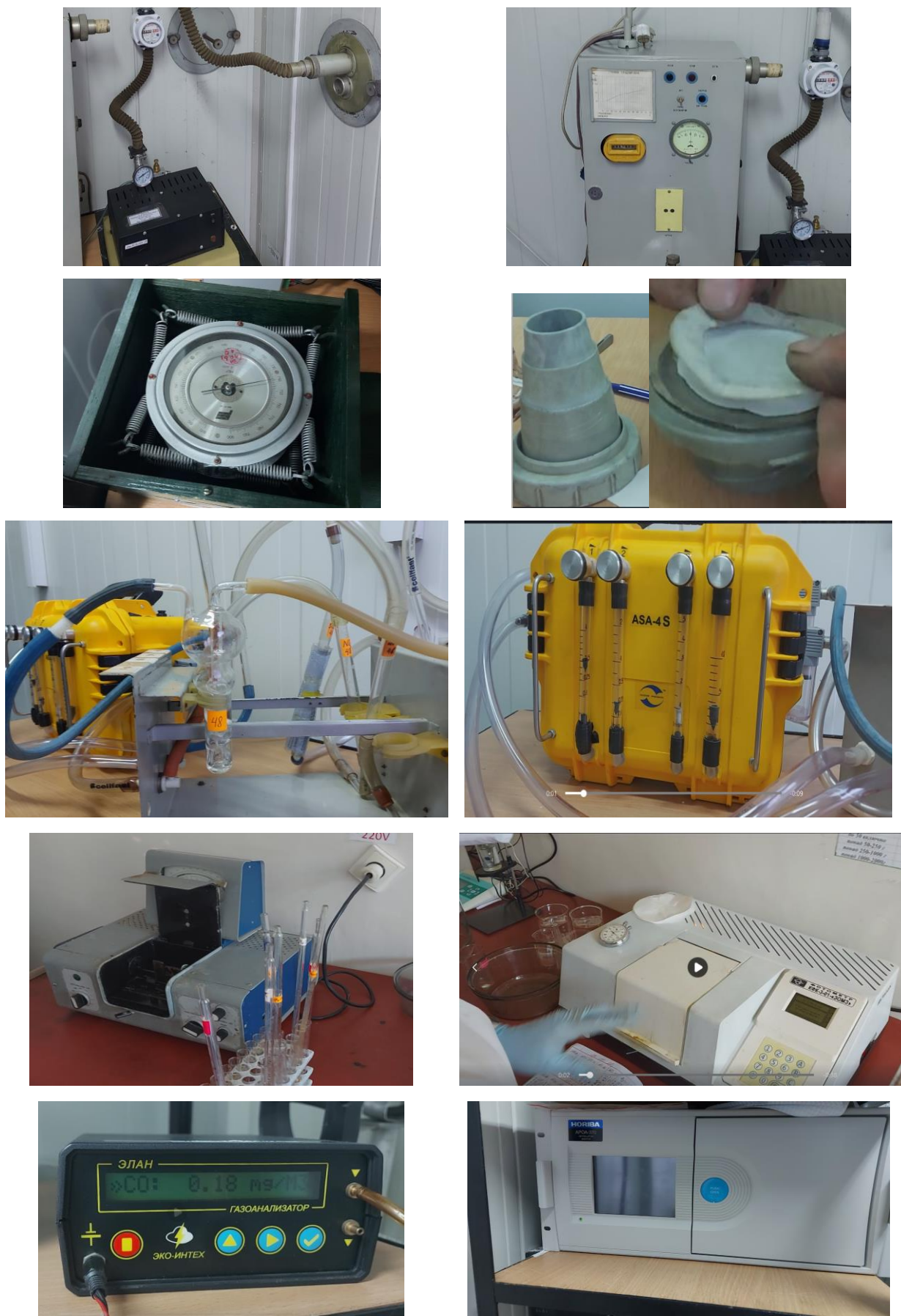
Фото 2. Засоби виміральної техніки, пристрої та устаткування, що використовуються для дослідження стану повітря на СП у м. Чернівці
