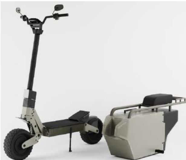
Рис. 1. Модульний транспортний засіб у вигляді самокату та демонтованим генератором
