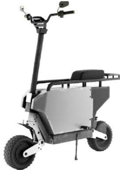
Рис. 2. Модульний транспортний засіб у вигляді скутера з встановленим генератором
