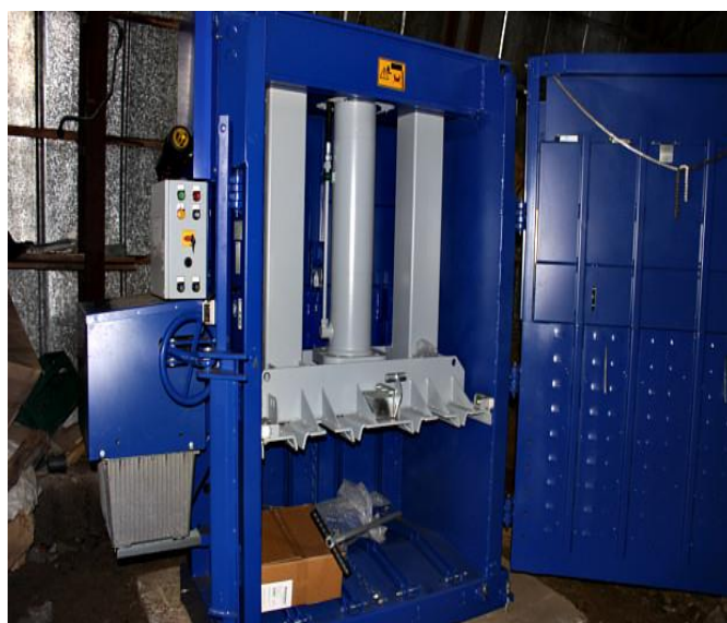
Фото 3.2. Однокамерний прес для пресування відходів, що здійснюється підприємством «КарпЕко-2010» у м. Сторожинець
