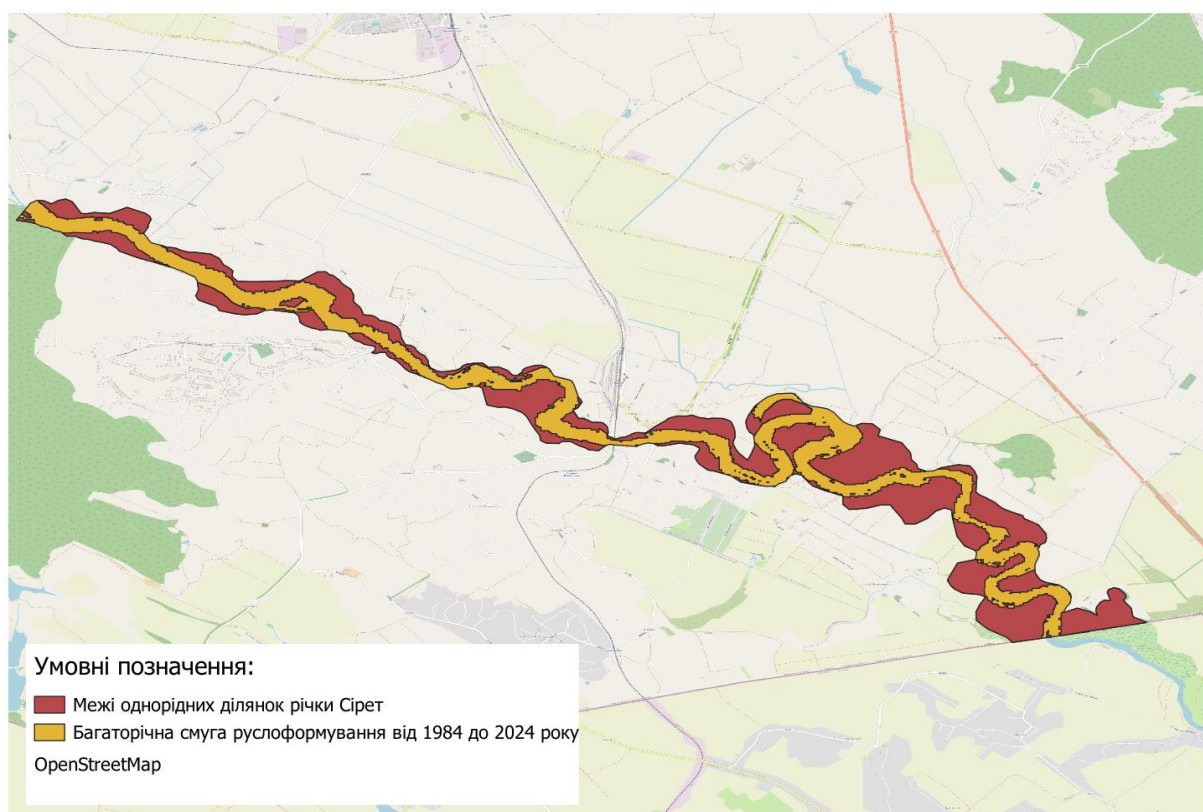
Рис. 3.22. Картосхема автоматично ідентифікованої багаторічної смуги руслоформування від 1984 до 2024 року з допомогою плагіна «Difference – multiple» для р. Сірет
