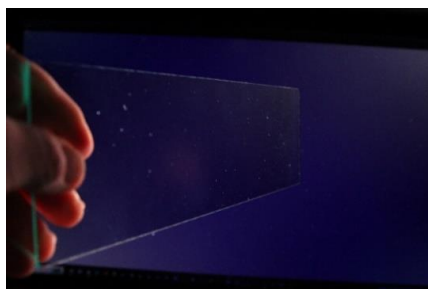
Фото 12. Скло розміщено вертикально. Відбите світло від поверхні скла блокується фільтром
