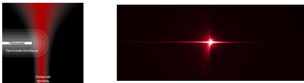
Схема 1 і фото 2. Рух світла біля перешкоди в просторовій бульбашці. Світло заломлюється в обидва боки, але інтерференція не спостерігається.
