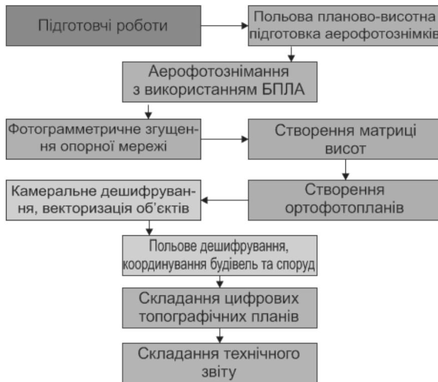
Рис. 3.6. Технологічна схема виконання аерофотозйомки з БПЛА
