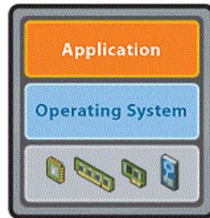
Рис. 4.2. Структура віртуальної машини (нижній рівень – фізичний) Розглянемо основні особливості віртуальних машин детальніше:
