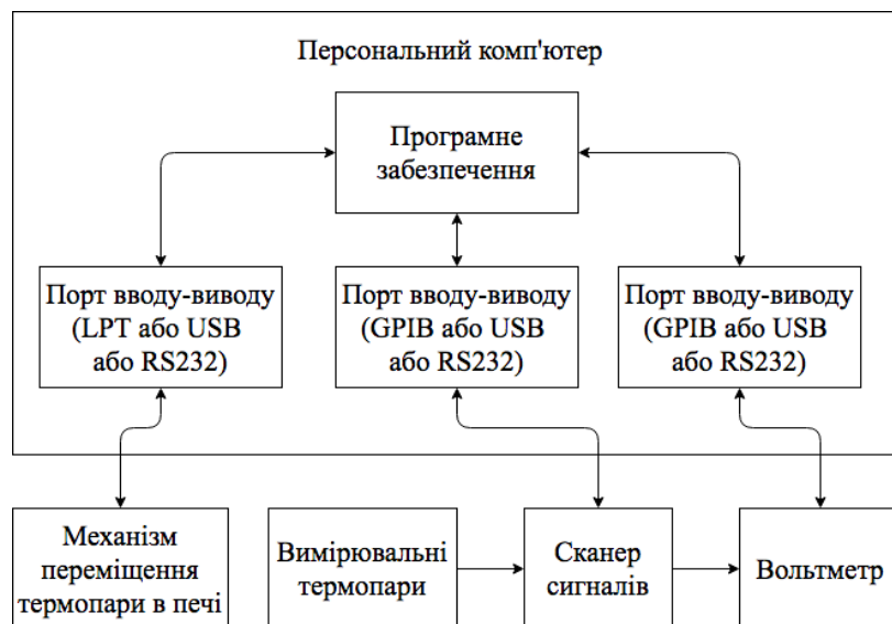
Рис. 1. Структурна схема установки для реєстрації температурного профілю в печі росту.
