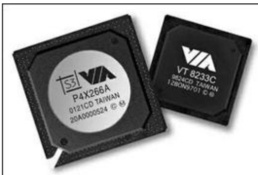
Дві мікросхеми, які складають типовий набір мікросхем. Модель P4X266A VIA, яка використовувалася в ранніх материнських платах для Pentium 4 процесорів
