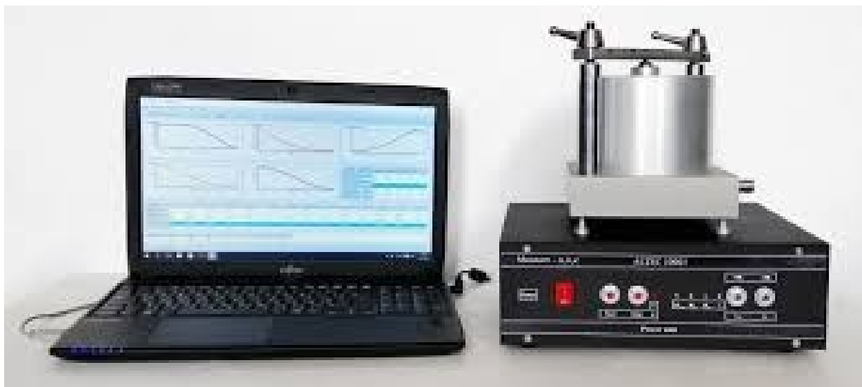
Рис. 4.2.1 – Автоматизована вимірювальна установка «Алтек-1001» [174]
