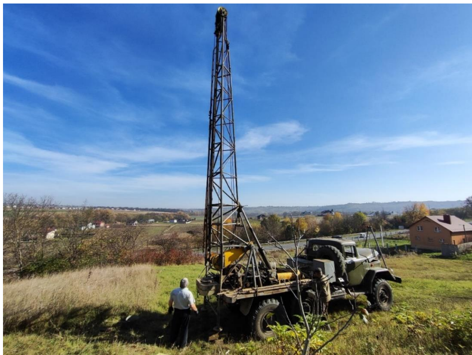
Рис. 1.3 Бурова установка УРБ-2.5А (з фотоархівів автора)
