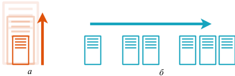
Рис. 1.10. Масштабування: а – вертикальне; б – горизонтальне
