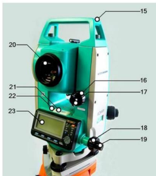
Рис. 2.2 Будова електронного тахеометра Sokkia SET610
