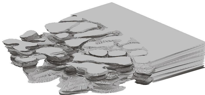
Рис. 1. 3D-модель фронту перекристалізації в процесі знеуглецювання
