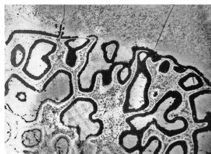
Рис. 1. 3D-модель фронту перекристалізації в процесі знеуглецювання
