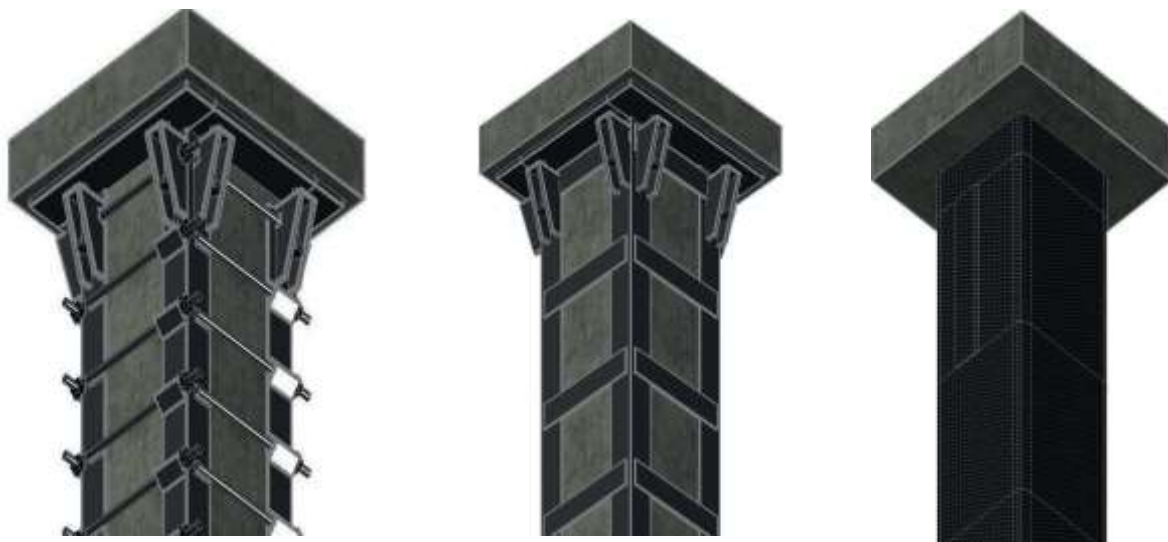
Рисунок 9 – Способи посилення залізобетонних колон: а) металева шпалера з можливістю обтиснення колони; б) класична металева обома з прокатних куточків; в) шпалери зі стрічок з композиційних матеріалів
