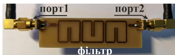
Рис. 2.12. Експериментальна модель смугового фільтра на основі трьох кільцевих резонаторів, з'єднаних каскадно.
