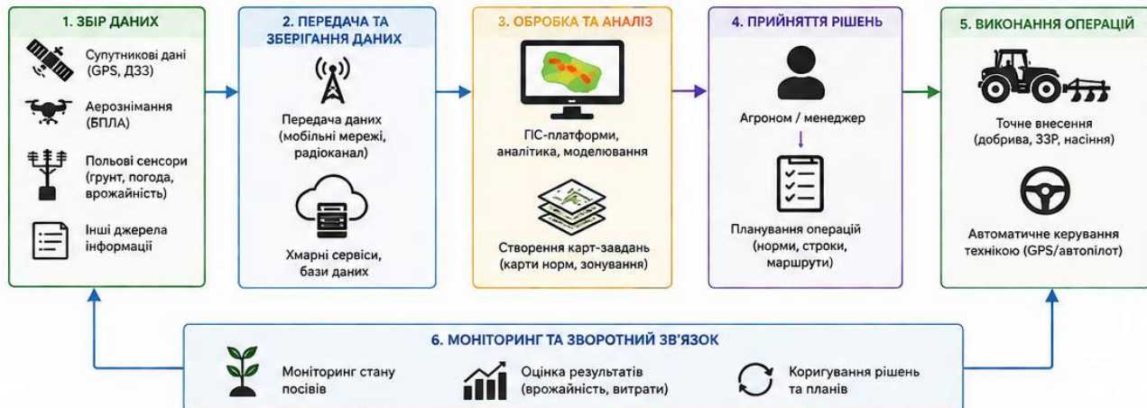
Рисунок 2. Узагальнена схема функціонування системи точного землеробства
