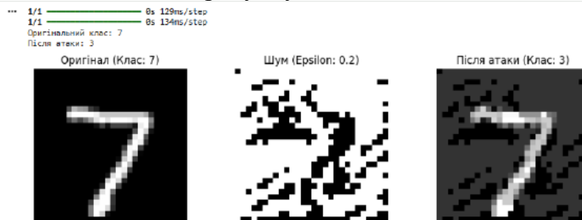
Рисунок 3 – Порушення роботи класифікатора
