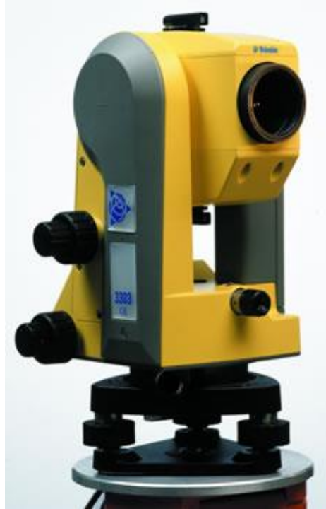
Рис. 3.8 Тахеометр Trimble 3305 DR
