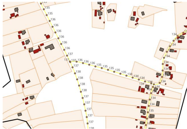
Рис. 3.15 Створення рівномірно розташованих вузлових точок з підписами висот вздовж лінійної геометрії центральної частини с.Чагор
