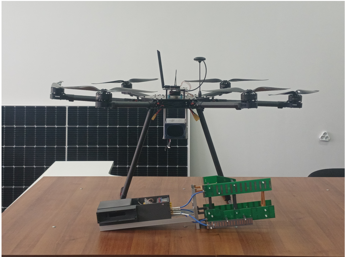
Рис. 3.5: Демонстрація інтеграційного потенціалу розробленого вузла. Апаратний блок SDR-сканера виконано у форм-факторі, сумісному з платформою носія, що обґрунтовує можливість застосування системи в сценаріях аеромоніторингу.
