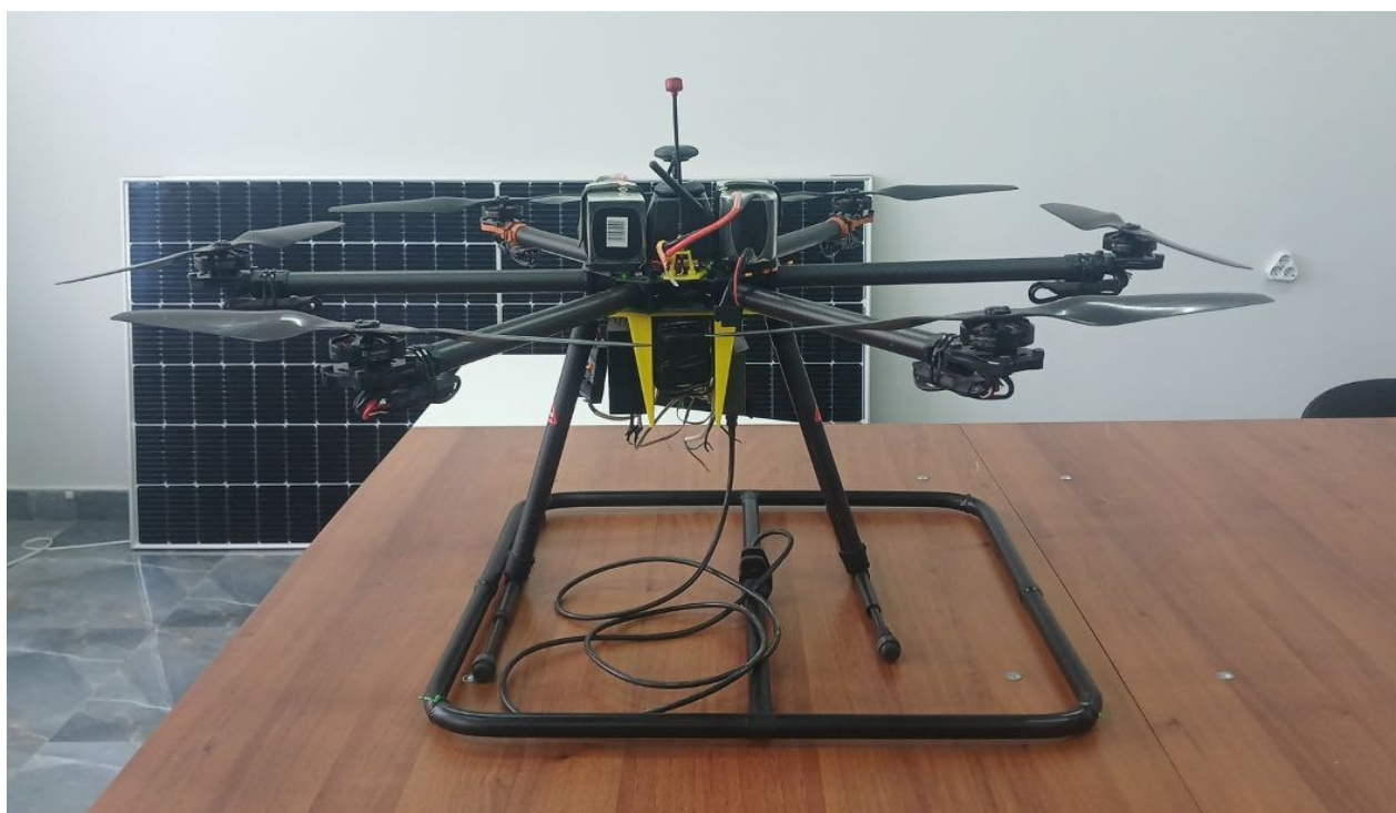
Рис. 3.10: Зовнішній вигляд мобільного вимірювального комплексу на базі БПЛА TAROT 960. Обчислювальний вузол SoC FPGA інтегровано в бортову мережу живлення та керування.
