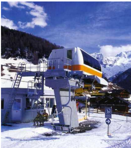
а) 2-ох місними. б) 4-ох місними; Рис.5.3. Дорога з фіксованими кріслами
