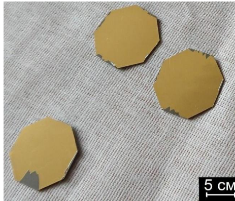
Рис. Д15. Зображення кристалів ФД із поганою адгезією Au.
