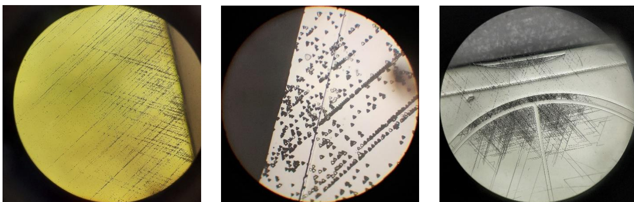
Рис. Д27. Зображення дислокацій вздовж лінії різання кремнієвих пластин диском з алмазованою зовнішньою кромкою.
