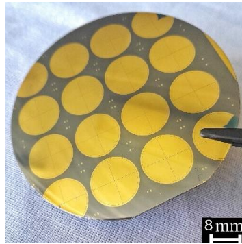
Рис. 3.35. Кристал ФД з меза-профілем в зазорах між ФЧЕ: а) схематичний переріз; б) кристали на підкладці із Cr-Au-маскуючим покриттям перед ХДП; в) кінцевий кристал.
