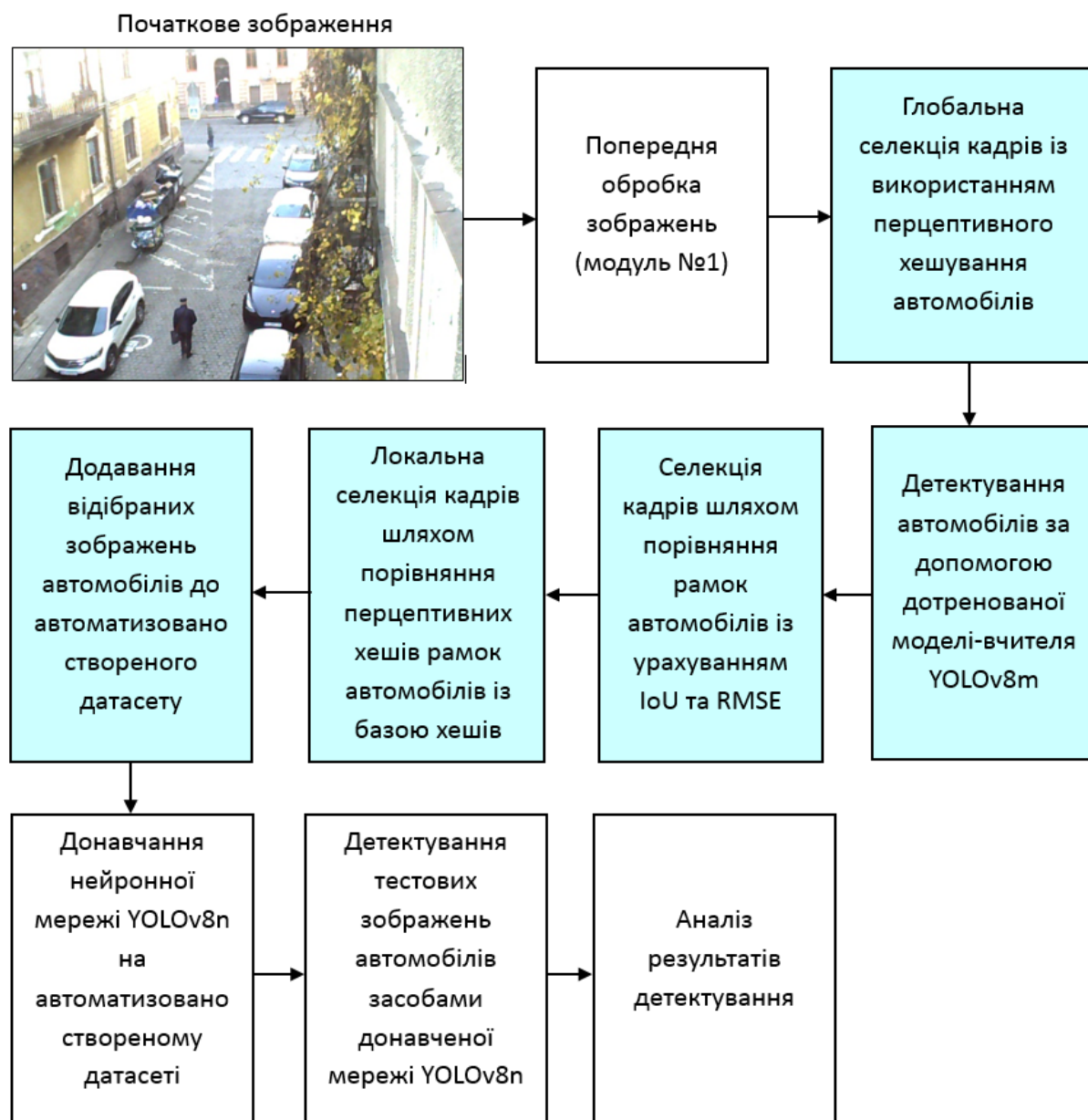
Рисунок 4.1 – Структура інтелектуальної системи для автоматизованого створення датасету та донавчання nano мережі YOLOv8n за допомогою мережі-вчителя YOLOv8m
