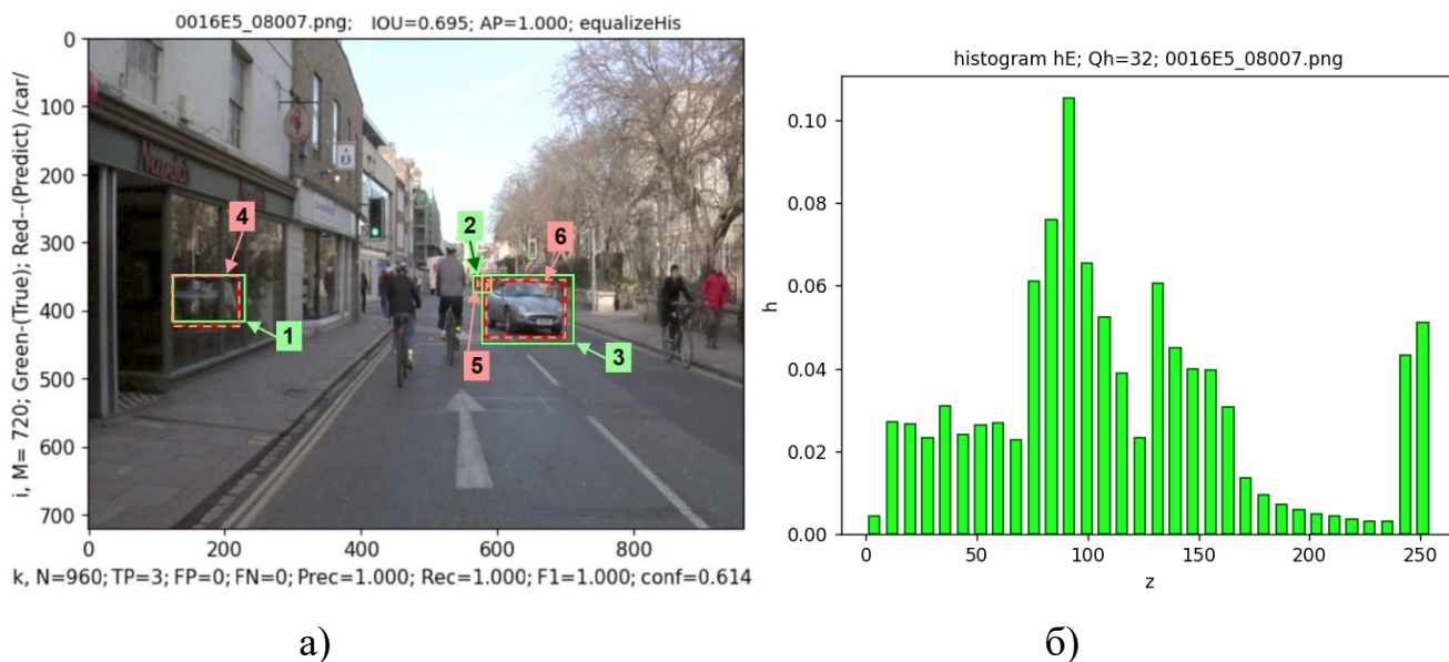
Рисунок 2.10 – Детектування автомобілів на зображенні ІЕ після еквалізації та центрування гістограми способом №3 (а) та гістограма hE(z) його каналу яскравості (б)
