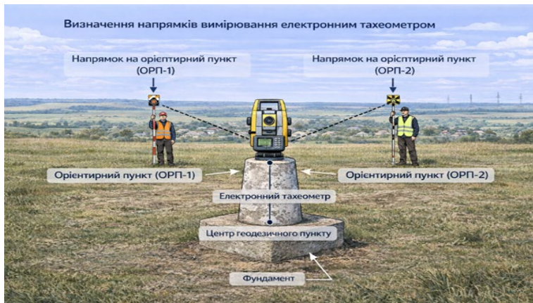
Рисунок 4.14. Визначення напрямків вимірювання електронним тахеометром
