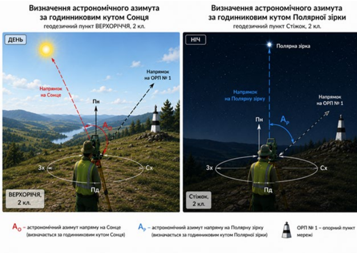
Рис. 4.23 Визначення астрономічного азимута
