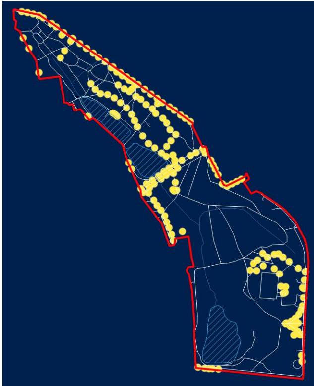
Рис. 3.16 Теплова карта розподілу світла від ліхтарів вуличного освітлення.
