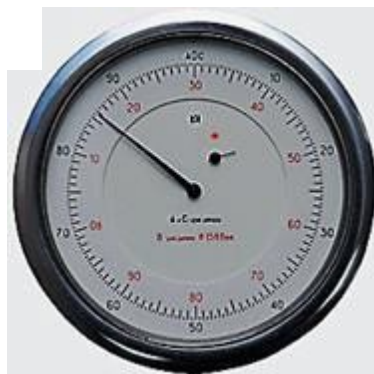
Рис.11.2. Шкала-індикатор твердоміра Роквелла.
