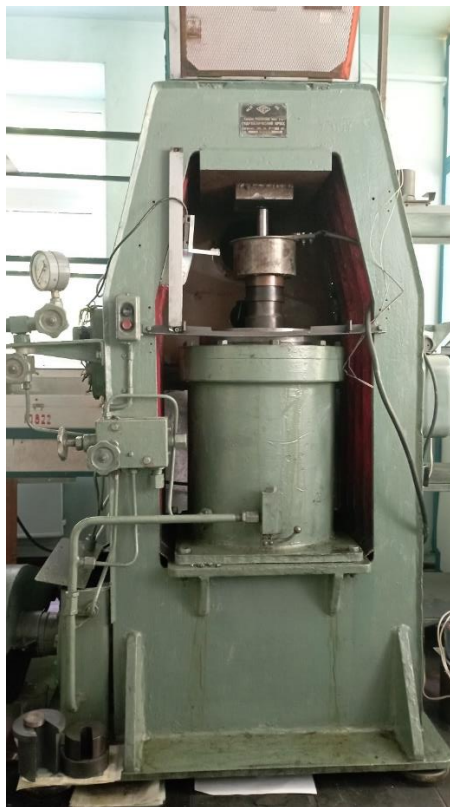
Рисунок 4.4. Загальний вигляд пресу для екструзії термоелектричних матеріалів
