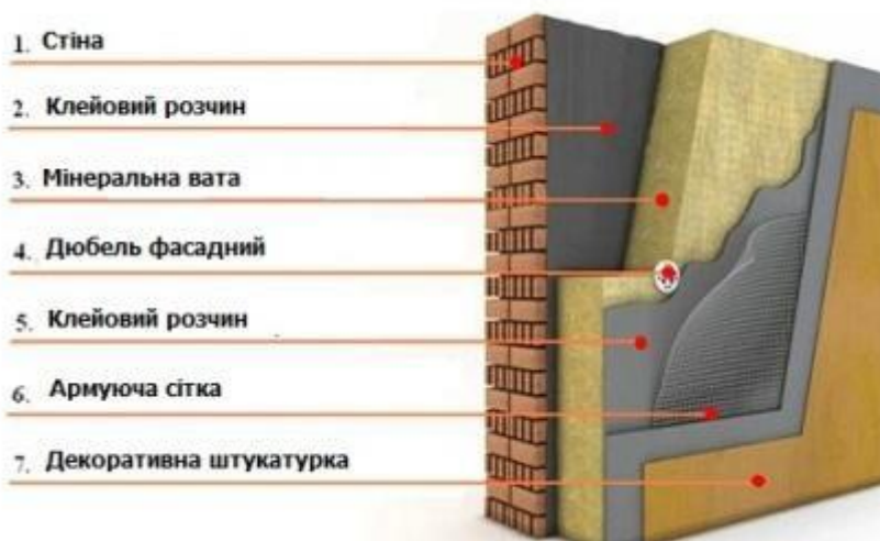
Рис 5 Вузол утеплення фасадної стіни
