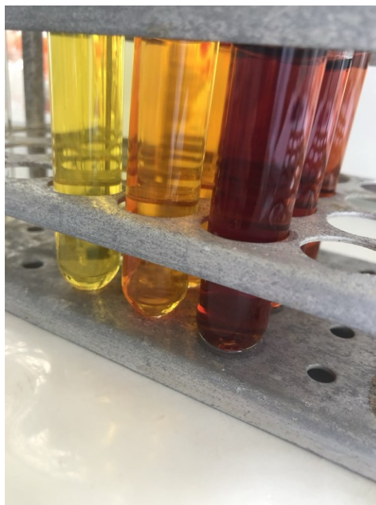
Рис. 2.2 Зображення квантових точок \text{AgInS}_2 з співвідношенням [\text{Ag}^+]:[\text{In}^{3+}] у порядку збільшення вмісту \text{Ag}^+ зліва на право, а саме 1:20; 1:7 та 1:3
